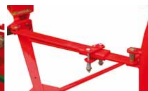
Széria kivitelű csillapító fék HIT 610 N-nél
