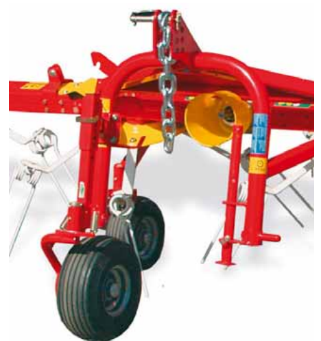
ALPINHIT H – Merev hidraulika függesztés
