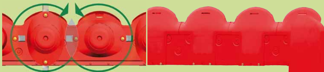
A futópályák optimált átlapolt fedése tiszta és egyenletes vágási képet biztosít.
